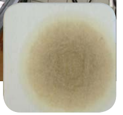
Een druppel olie of remvloeistof op de kaart aanbrengen en dan is het wachten op de verkleuring.
