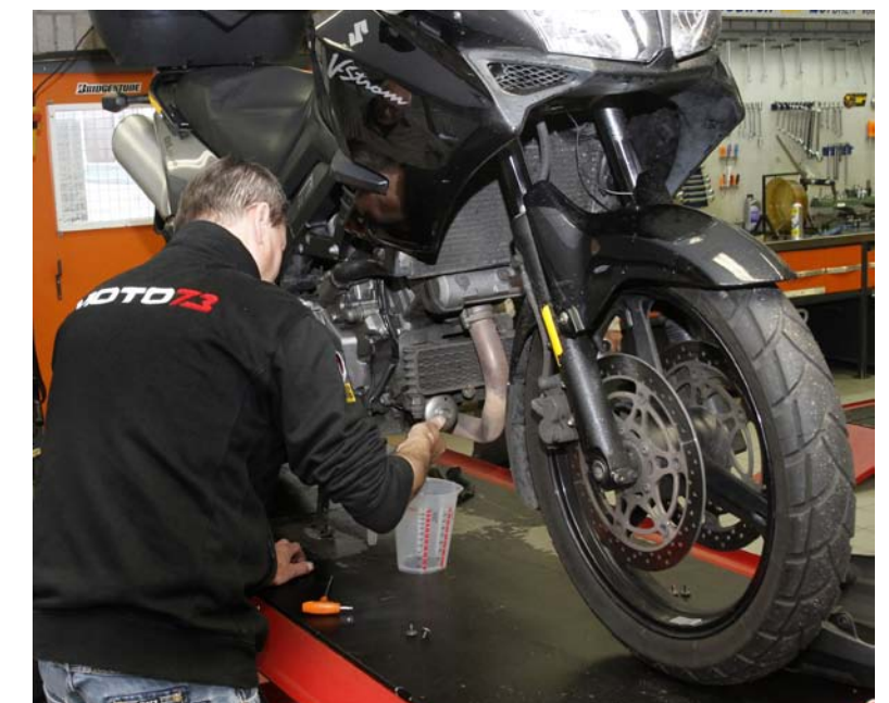
Er hoeft slechts een heel kleine beetje olie te worden afgetapt voor de test.
