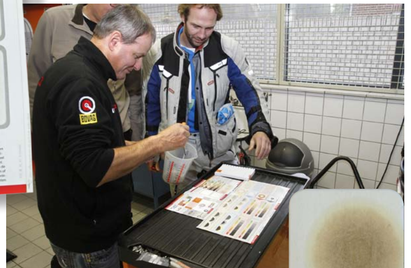
Een druppel olie of remvloeistof op de kaart aanbrengen en dan is het wachten op de verkleuring.
