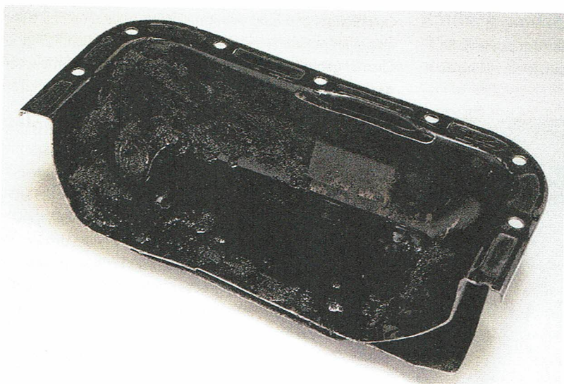
Een defecte turbo is vaak het gevolg van een olieprobleem. "Een engine flush kan afzettingen in het carter en in de olieleidingen losmaken en ophoping voorkomen", zegt Tim Saerens van Wynns.
